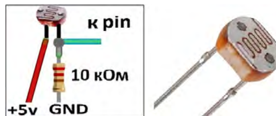
Рис. 4. Схема подключения фоторезистора к Ардуино
