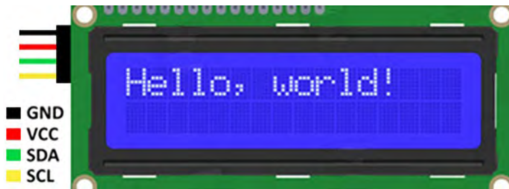
Рис. 1. Подключение модуля ЖКИ к Ардуино
