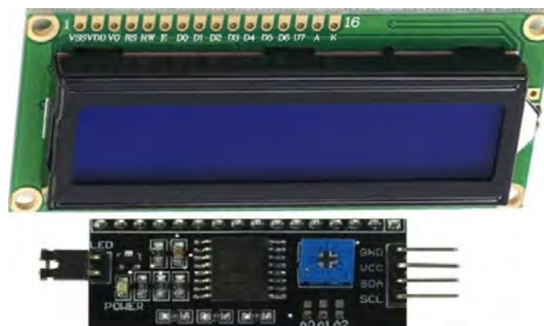
Рис. 17. Дисплей (жидкокристаллический индикатор — ЖКИ 16×2)
